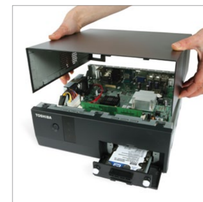
ACCESO A COMPONENTES INTERNOS SIN HERRAMIENTAS - Incluyendo la extracción rápida del disco duro desde el panel frontal
